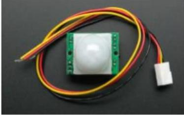
A PIR motion sensor module with a white sensor lens, a green PCB, and four colored wires (red, yellow, black, blue) connected to a white connector. | निष्क्रिय इन्फ्रा-रेड मोशन सेंसर या सिर्फ पीआईआर सेंसर व्यापक रूप से इस्तेमाल किया जाने वाला सेंसर है। इनका उपयोग गति का पता लगाने में होता है और यह 120 डिग्री से 360 डिग्री तक विशाल आकार और रेंज में उपलब्ध होता है। यह एक बड़े क्षेत्र और एक लंबी सीमा में गति का पता लगा सकते हैं।                            |
