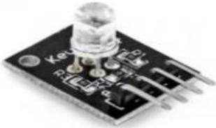
A small black PCB with a clear lens, labeled 'RGB LED', and four pins extending from the bottom.                                                    | इन एल ई डी का उपयोग स्पेक्ट्रम में लगभग हर रंग का उत्पादन करने के लिए किया जा सकता है। कारण यह है कि मस्तिष्क दो अतिव्यापी रंगों को अलग नहीं कर सकता है और इसलिए यह एक नए रंग का भ्रम पैदा करता है। तिरंगा या आरजीबी लाल, हरे और नीले रंग की विभिन्न मात्राओं को मिलाता है। यह पानी के रंगों को मिलाने के समान है। |
