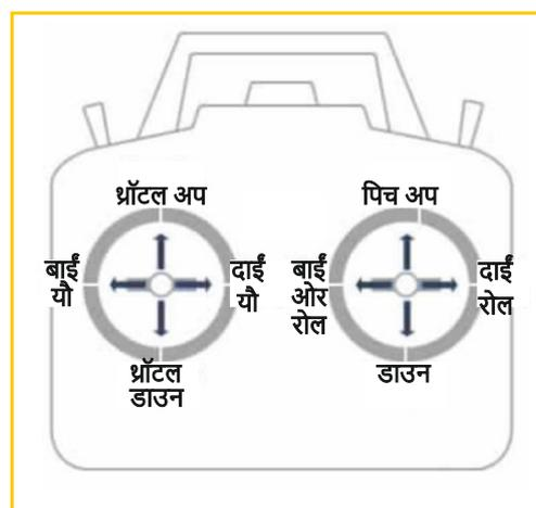
चित्र 4.3 आरसी जॉयस्टिक कंट्रोल चित्र
